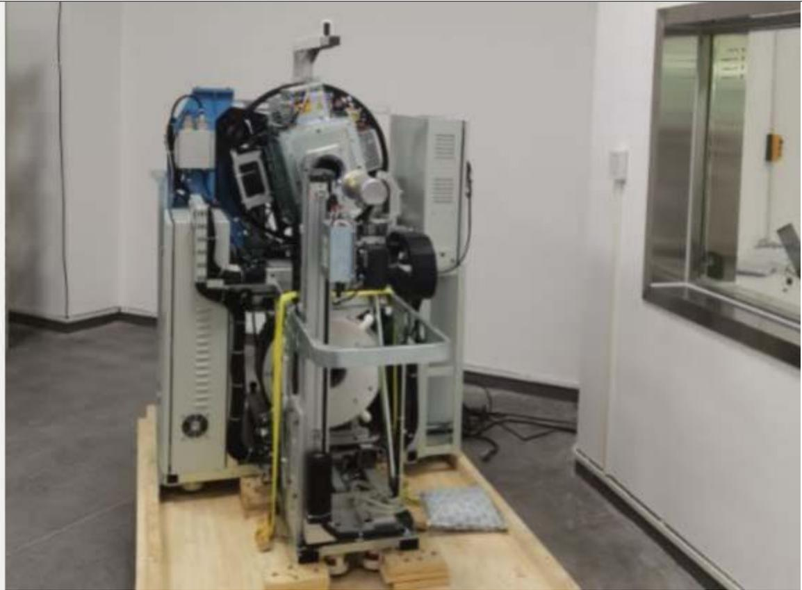
图 2-5 本项目 PET/SPECT/CT 一体机现场照片
