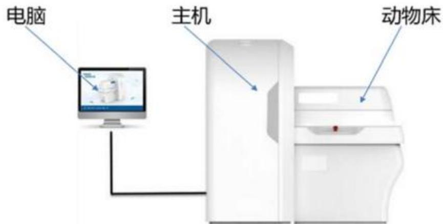
图 2-5 本项目 PET/SPECT/CT 一体机结构示意图
