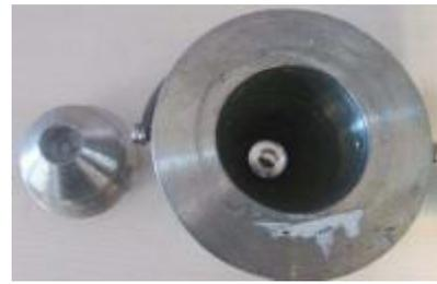
图 2-7 涉及分装操作的放射性核素外包装及其屏蔽铅罐照片
