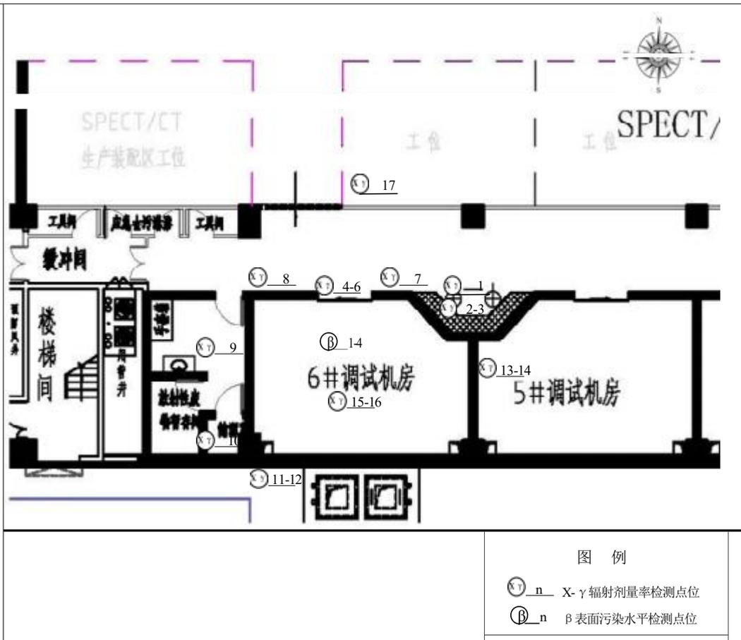
图 6-1 6#调试机房现场检测点位示意图
